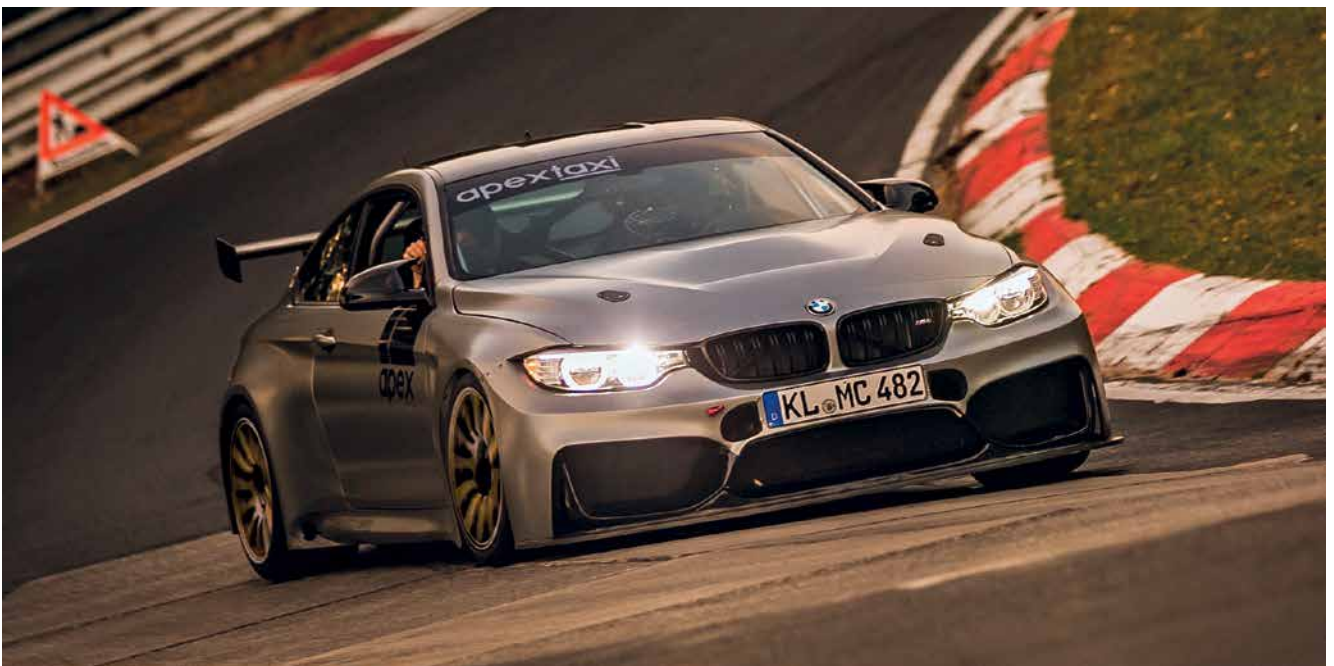
Bild 1: Auf dem apex nürburg Ringtaxi auf Basis des BMW M4 sind im Flow Forming Verfahren hergestellte PROTRACK ONE Motorsporträder in der Größe 11,0 x 18 Zoll rundum auf beiden Fahrzeugseiten in unterschiedlichen Farben montiert.
