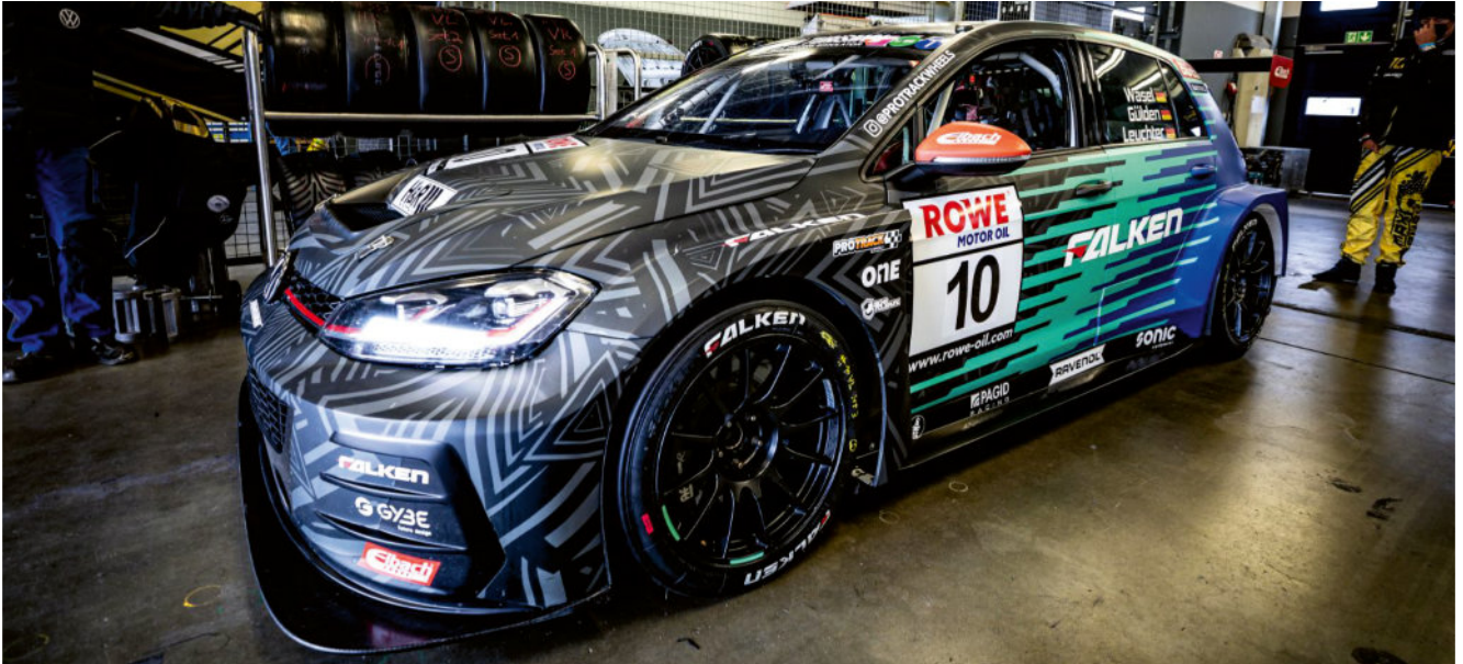
Bild 2: Das im Flow Forming Verfahren produzierte PROTRACK ONE ist auf den beiden VW Golf GTI TCR von Max Kruse Racing in der Größe 10.5 x 18" an der angetriebenen Vorderachse und in 10.0 x 18" an der Hinterachse montiert. © Gruppe C
